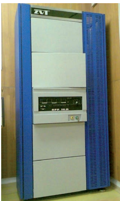
Obr. 5 Inovované stojanové vyhotovenie počítača RPP 16 M, vystavené v SV DVT SAV
