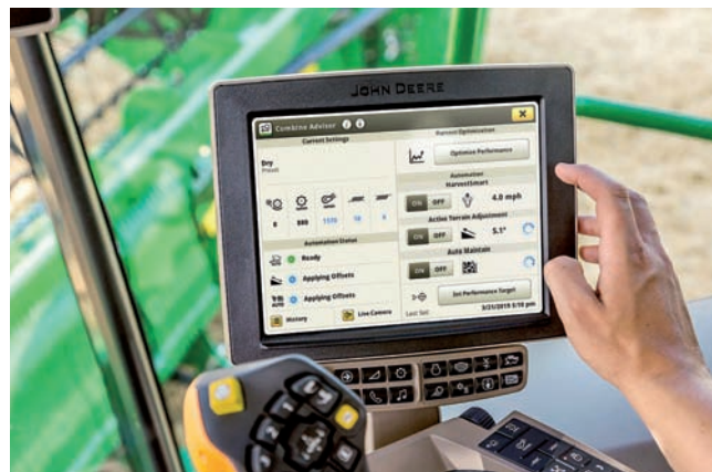
Systém Combine Advisor používa kamery a snímače zoskupené v rámci technológie ActiveVision™ na identifikáciu plodín a zmien, ktoré s nimi súvisia, a automatické prispôsobenie kombajnu tak, aby zabezpečil optimálny výkon v rôznych podmienkach.
