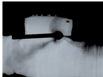
Obr. 9 Lokalizácia úniku plynu infračervenou kamerou FLIR GF 320
