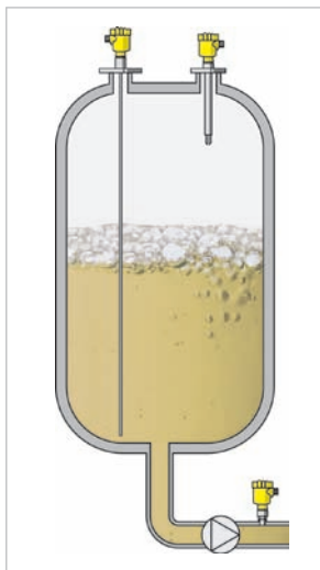
Ochrana čerpadla proti chodu naprázdno či ochranu nádrže proti preplneniu spoľahlivo zabezpečia vibračné hladinové spínače Vegaswing 63
