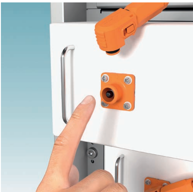
Obr. 3 Ochrana proti dotyku ako hlavný faktor bezpečnosti pri inštalácii: technológia pripojenia batériového modulu musí spĺňať stupeň krytia IP20, aj keď nie je pripojená, takže zabráni nechcenému dotyku živej časti.
