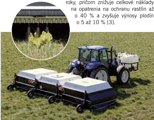
Vďaka postrekovaču ARA sú poľnohospodári schopní ušetriť až 95 % prípravkov na ochranu rastlín v porovnaní s bežnými postrekovacími zariadeniami. Zariadenie je extrémne presné a aplikuje ochranu na plochu s rozmermi 3 x 8 cm.
