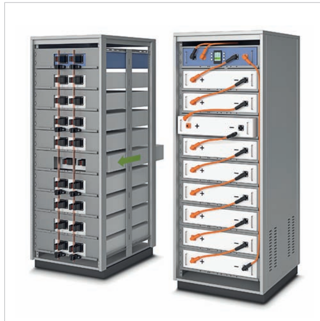
Obr. 4 Porovnanie riešení pre racky: zásuvný systém, ktorý umožňuje priamy kontakt s prípojnícami (vľavo), spolu s flexibilným káblovým riešením prostredníctvom zásuvných konektorov (vpravo).
