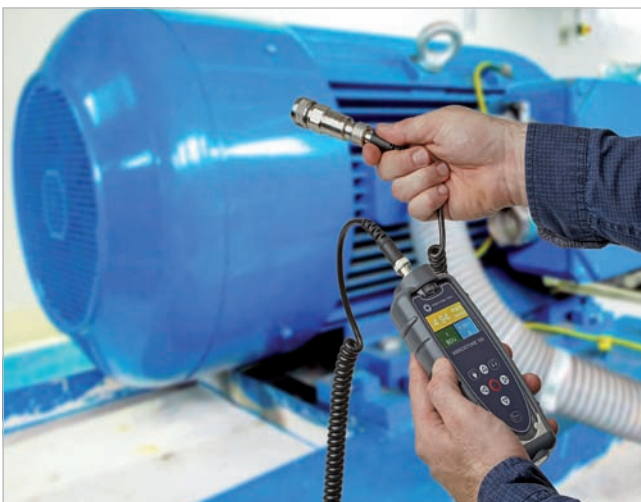
Obr. 1 Typická profesionálna zostava na pochôdzkovú (off-line) diagnostiku
